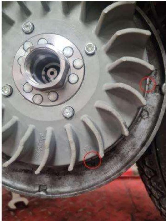
**DISCO DE TIEMPO.** Retire el volante y coloque un disco de distribución. Busque la flecha superior del disco de sincronización y gírela directamente hacia el centro de las marcas que hizo en la carcasa del cargador. Encuentre los 21 grados, marque la carcasa Mag en la marca 21 en el disco de sincronización antes del punto muerto superior.
